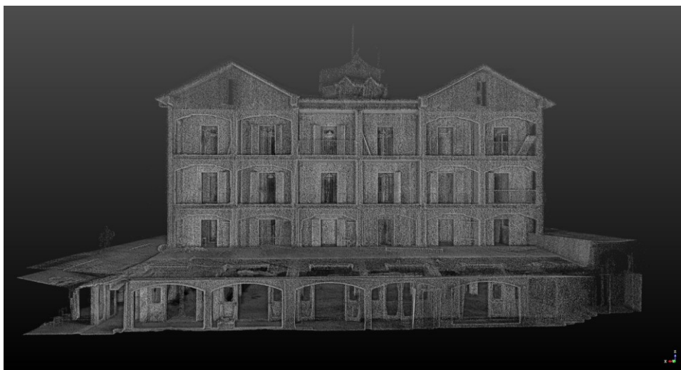
Edificio rilevato con il TIMMS - nuvola di punti per riflettanza
