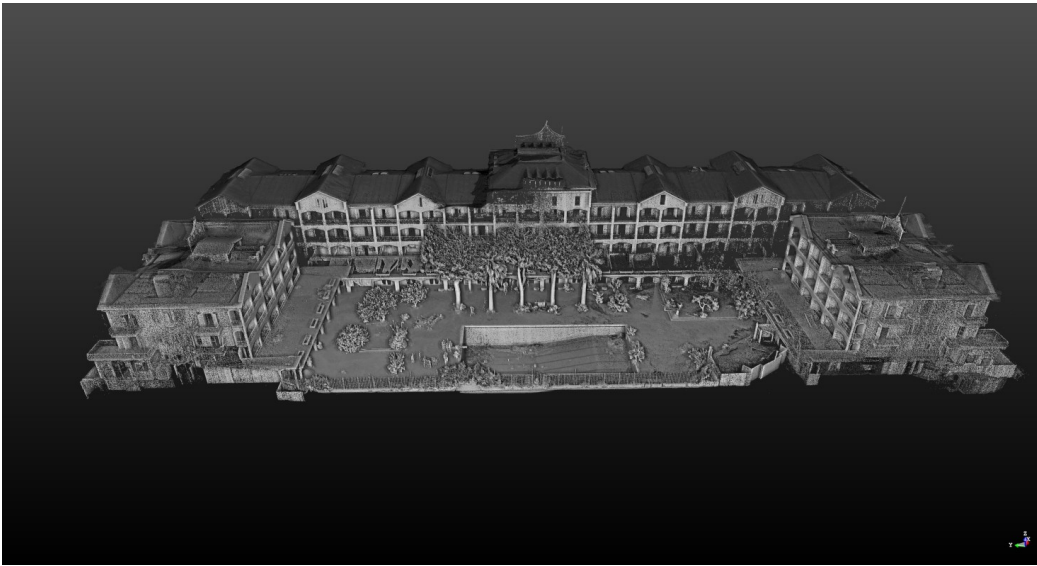
Nuvola di punti TIMMS & UAV (tetti) per riflettanza
